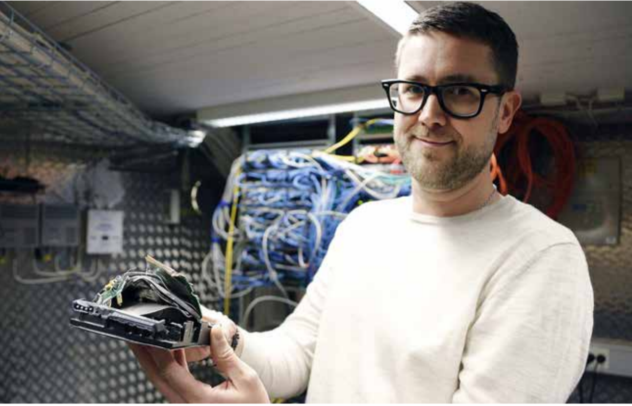
Att fysiskt förstöra hårddiskar till datorer kan verka drastiskt, men det är ett av få sätt där man kan garantera att informationen som funnits på disken inte går att återskapa. Christian Hellemar, affärsområdeschef för IT på Front, demonstrerar hur en hårddisk ser ut efter att den körts i deras kross.
